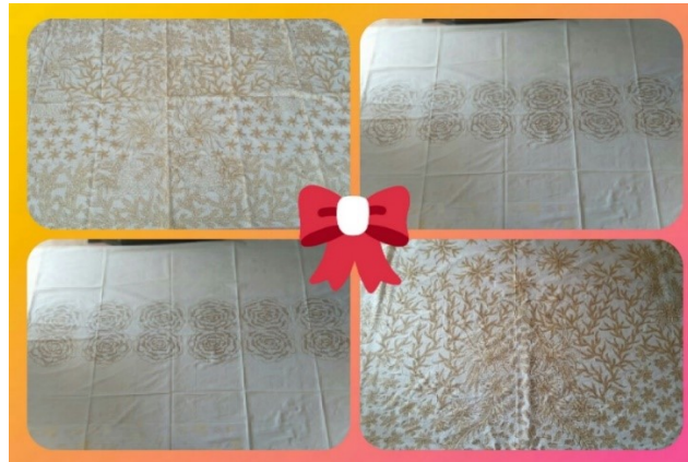
Gambar 7. Produk pembatikan serat katun jepang menggunakan malam batik modifikasi LMT-GR (kiri atas); LMT(kanan atas); LMT-K (kiri bawah); dan LMT-P (kanan bawah) secara mandiri oleh UMKM mitra
